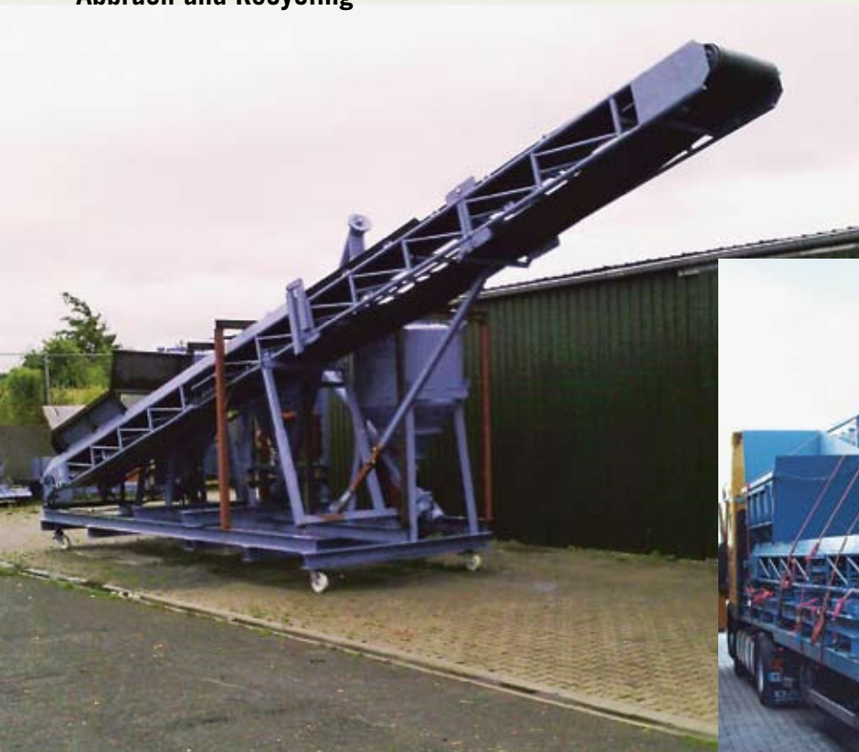
Die mobile RSS Kompaktanlage produziert qualitätsgerechten Flüssigboden und fördert ihn direkt in den Fahrmischer. Fotos: rss
