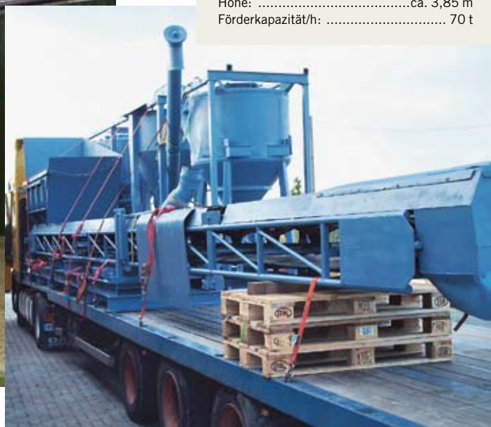
Die mobile RSS Kompaktanlage produziert qualitätsgerechten Flüssigboden und fördert ihn direkt in den Fahrmischer. Fotos: rss
