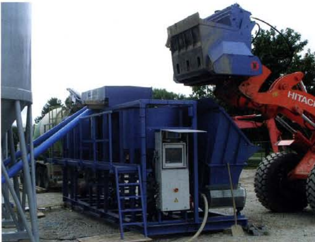
Einsatz der Dosiereinheit an der Kompaktanlage. Foto: PROV
