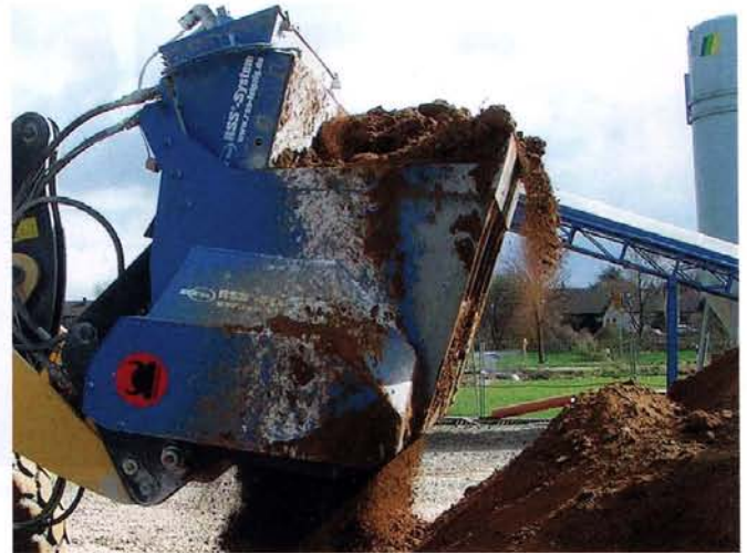
Die neuen Schaufelseparatoren lassen sich flexibel und wirtschaftlich einsetzen. Foto: PROV
