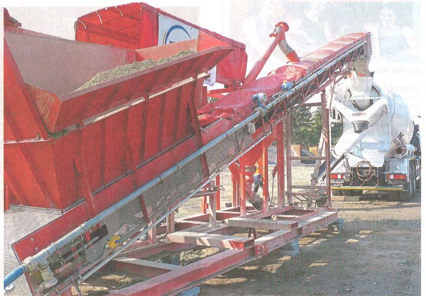
Der Bodenaushub von einer Baustelle wird auf diesem Förderband gesiebt und nach seiner Körnung getrennt, um dann angereichert mit Bindemittel und Wasser im Mischer zu landen, der den Flüssigboden zurück zur Baustelle befördert. Foto: gh
