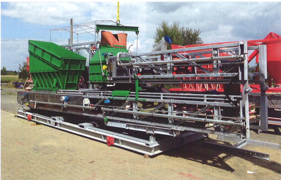
Zum den wesentlichen Verbesserungen der Anlagentechnik gehört das klappbare Förderband.
