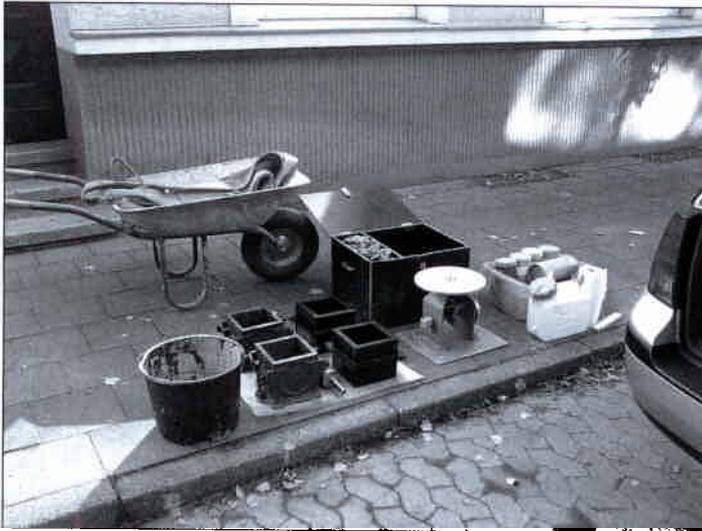
Abbildung 8: Probenbehälter zur Bestimmung von Wasserdurchlässigkeit (k-Wert) und Würfeldruckfestigkeit
