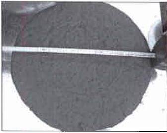
Abbildung 2: Überprüfung der Fließfähigkeit und Rezeptur (Ausbreitmaß)
