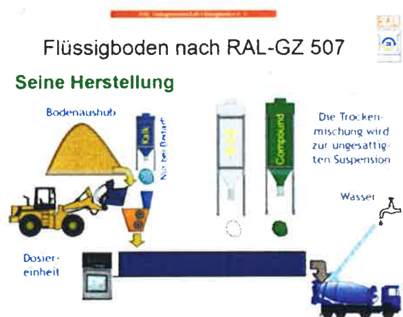
Abbildung 1 Herstellung des Flüssigbodens nach RAL-GZ 507
