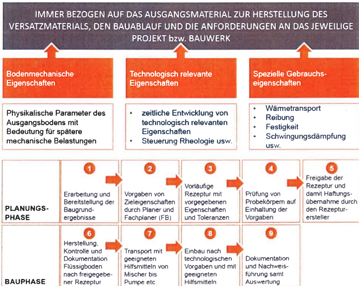
Abbildung 7 Eigenschaften (oben) und Darstellung des Prozesses (unten) der Gütesicherung nach RAL GZ 507
