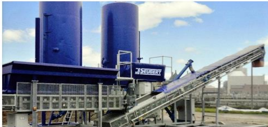
So sieht die Anlage aus, mit der Erdaushub zu Flüssigboden umgewandelt wird.
